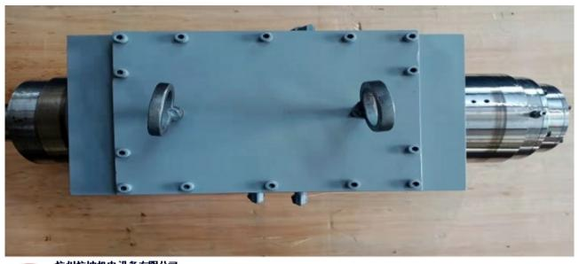
杭州杭坤机电设备有限公司 诚挚欢迎新老客户选购!!! 圆锥动静压镗头的轴向承载力不如平面止推动静压镗头,因此常用于轴向承载要求不高的场合。由于其功耗小,特别适用于高速内圆磨头主轴系统,如M2110内圆磨头。近年来已应用在电主轴和内沟道磨床中。液体静压轴承的发展1862年,法国的L.D.吉拉尔发明液体静压轴承,指出摩擦系数可小至1/500。1917年,英国科学家瑞利发表求解液体静压推力轴承的承载能力、流量和摩擦力矩方程。1938年,美国在大型天文望远镜上应用液体静压轴承,承载总重量500吨,每昼夜转动一周,驱动功率只1/12马力。1948年法国开始把液体静压轴承用于磨床上。现代液体静压轴承已成功地用于重型、精密、高效率的机器和设备上。杭坤动静压镗头安全源于品质,专业源自责任!云南平面磨床动静压镗头进货价
